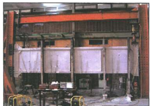
شکل (۶): مدل Set up شده دیوار برشی چهار طبقه [۴]
