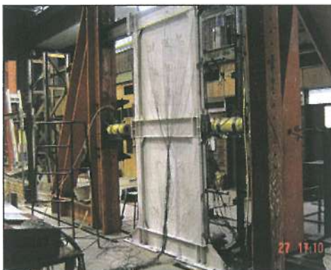
شکل (۴)، مدل Set up شده دیوار برشی دو طبقه [۱]
