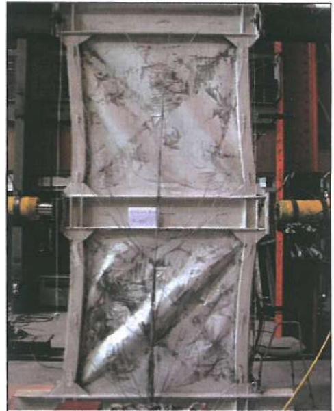
شکل (۷): دیوار برشی چهار طبقه در انتهای آزمایش [۴]
