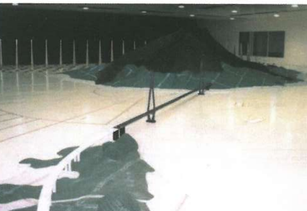
تصویر (۱۰) - ماکت کامل پل در تونل باد [۳]
