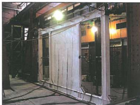
شکل (۸): مدل آزمایشگاهی قاب تقویت شده با دیوار برشی فولادی [۴]
