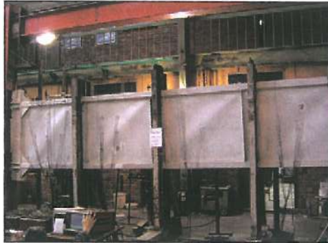
شکل (۷): دیوار برشی چهار طبقه در انتهای آزمایش [۴]
